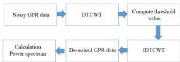
شکل ۵: الگوریتم طراحی‌شده در حوزه DTCWT به منظور تضعیف نوفه سیگنال‌های روش GPR.
