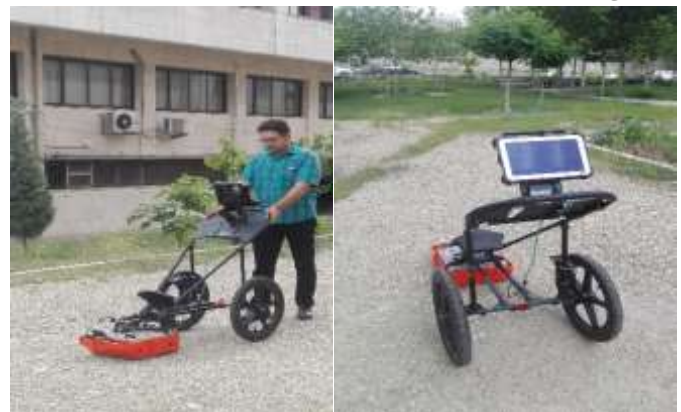
شکل ۱۰: برداشت داده‌های GPR در محوطه باز موسسه ژئوفیزیک دانشگاه تهران توسط آنتن ۳۰۰-۸۰۰ MHz متعلق به شرکت GSSI به منظور شناسایی تاسیسات زیرسطحی.
