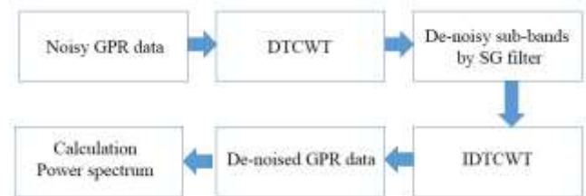
شکل ۶: الگوریتم طراحی شده توسط فیلتر SG در حوزه DTCWT به منظور تضعیف نوفه سیگنال های روش GPR.
