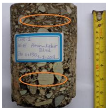
شکل ۸: وجود عدم یکنواختی و فضای خالی اضافی در عمق چهار سانتی متری و قسمت‌های انتهایی از سطح مغزه در کیلومتر ۱۵۰+۰ غرب به شرق بلوار امیرکبیر.
