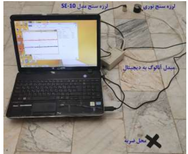
شکل ۷: چیدمان آزمایش انجام شده بر روی لرزه‌سنج ماره‌ای و الکترومغناطیسی.
