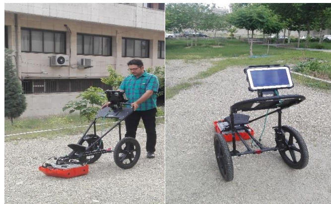
شکل ۱۰: برداشت داده‌های GPR در محوطه باز موسسه ژئوفیزیک
