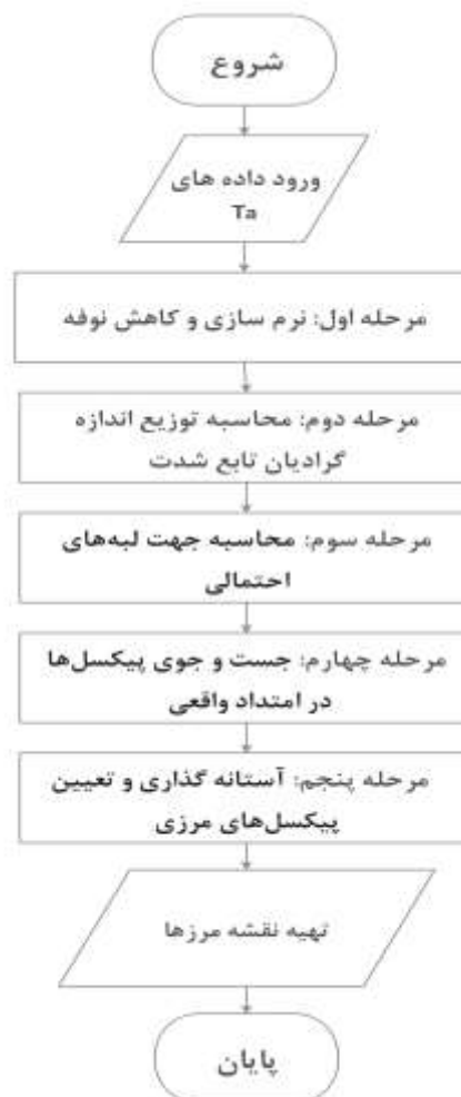
شکل ۲: روند نمای اجرای صافی کنی بر روی نقشه اندازه دامنه میدان مغناطیسی ( T_a ).
