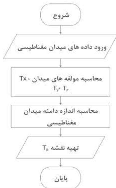
شکل ۱: روند نمای تهیه نقشه اندازه دامنه میدان مغناطیسی ( T_a ).
