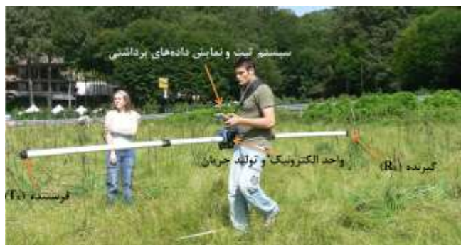
شکل ۱۱: تصویری از برداشت داده‌های دستگاه EM31 در یک منطقه صنعتی در شهر ناپل، کشور ایتالیا. در این تصویر اجزاء مختلف دستگاه EM31 مشخص شده است.
