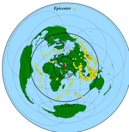
شکل ۳: توزیع رومرکز زمین‌لرزه‌های دور لرز استفاده شده برای محاسبه توابع گیرنده P. دایره‌های زرد رنگ نماینده رومرکز زمین‌لرزه‌های دور لرز و مثلث قرمز رنگ مرکز منطقه‌ی کرمانشاه و خرم‌آباد است. دو دایره سیاه رنگ در فواصل 30^\circ و 95^\circ ، فواصل رومرکزی را از مرکز مشخص می‌کنند.
