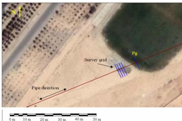
شکل ۳: تصویر ماهواره‌ای منطقه برداشت به همراه پروفیل‌های برداشتی و امتداد تقریبی لوله (محمدی و یژه و همکاران، ۱۳۸۷).
