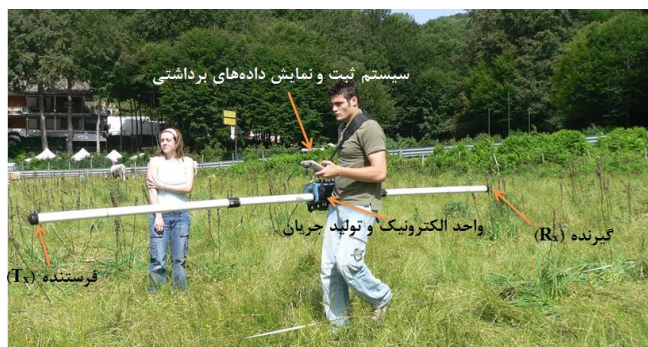
شکل ۱۱: تصویری از برداشت داده‌های دستگاه EM31 در یک منطقه صنعتی در شهر ناپل، کشور ایتالیا. در این تصویر اجزاء مختلف دستگاه EM31 مشخص شده است.
