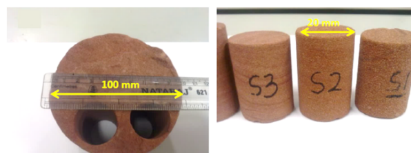
شکل ۱: نمونه‌های استوانه‌ای آبخوان ماسه‌سنگی با قطر ۲۰ میلی‌متر و طول حدود ۴۰ میلی‌متر که از مغزه‌ی ماسه‌سنگی با قطر ۱۰۰ میلی‌متر استخراج شده‌اند.
