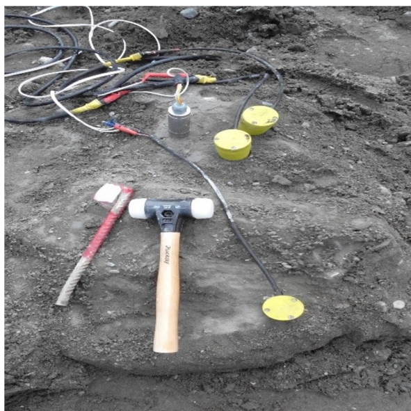
شکل ۳: آزمون پاسخ ضربه شامل یک شتاب‌نگار و سه ژئوفون به رنگ زرد (یکی از ژئوفون‌ها به عنوان تریگر و دوتای دیگر به عنوان گیرنده) و چکش با سری مخصوص پلاستیکی.
